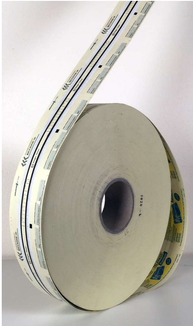
Figura 3. Posizione tacca rispetto a verso di srotolamento.
